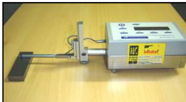
Figura 8 - Rugosímetro Taylor Hobson - medição dos parâmetros topográficos
