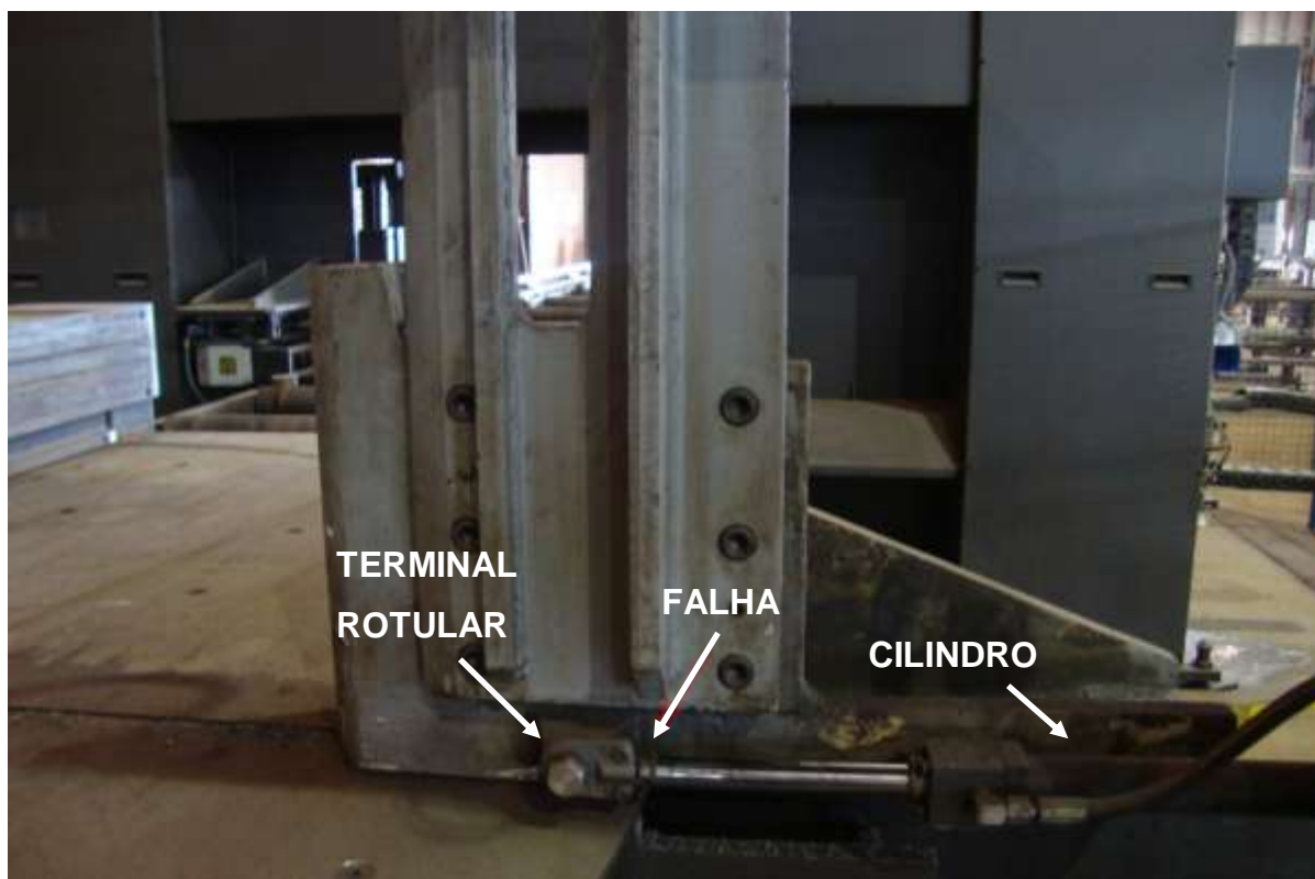
Figura 7: Morsa com seu sistema de acionamento e fixação. Indicação de onde ocorreu a falha
