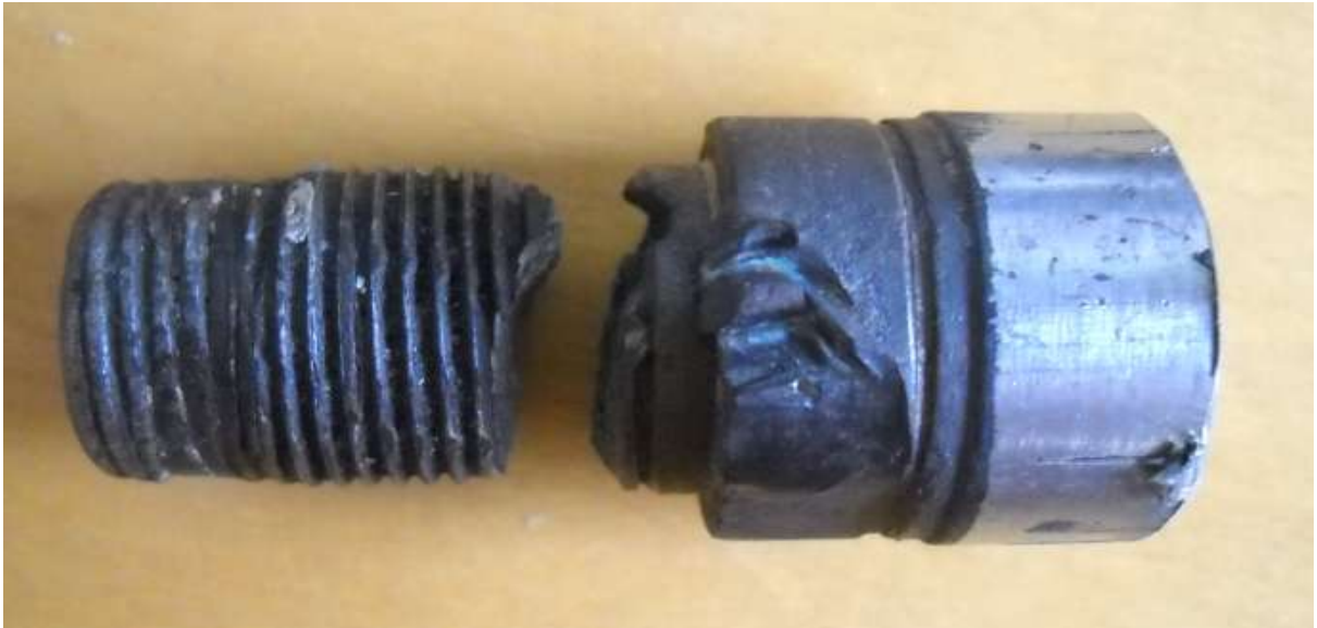
Figura 10: Fratura no parafuso do terminal rotular de fixação.
