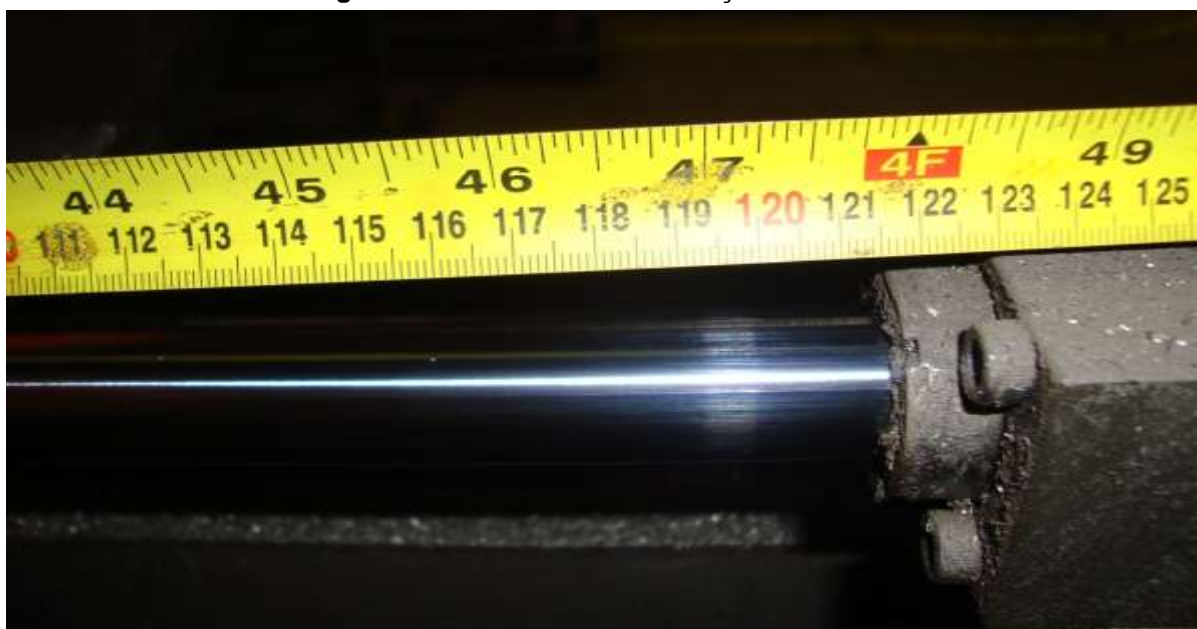
Figura 9: Medição do curso da haste do cilindro totalmente aberto, 1215 mm.
