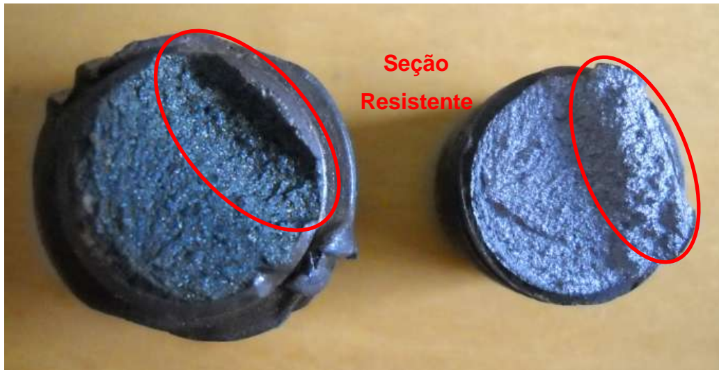
Figura 11: Visualização de topo da falha explicitando a seção resistente da peça
