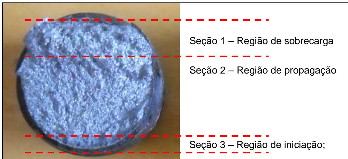
Figura 12: Indicações das seções onde foram feitas as microscopias pelo MEV
