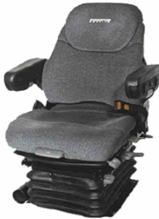
Figura 5. Assento de um veículo pesado com amortecedor MR.
