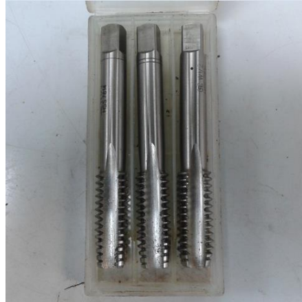
Figura 3.6 – Jogo de machos OSG W1/2(12,7mm) utilizado para abertura das roscas internas para fixação das hastes da alavanca do dispositivo.
