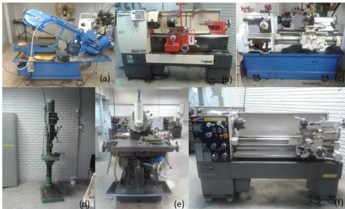
Figura 3.5 – Máquinas-ferramenta: (a) Serra Fita; (b) Torno Revolution RV220; (c) Torno Universal IMOR; (d) Furadeira de coluna; (e) Fresadora Vertical WMW; (f) Torno Universal Mascote MS 205.
