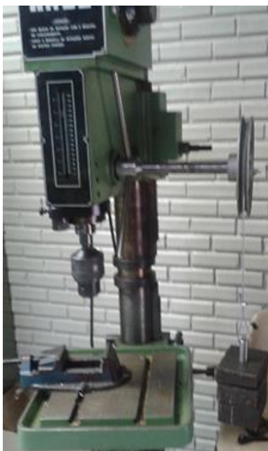
Figura 3.15 – Dispositivo para execução de ensaios de usinabilidade de pressão constante montado no eixo de avanço da furadeira de coluna.
