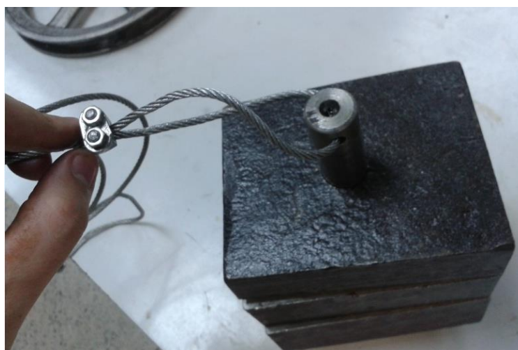
Figura 3.13 – Pesos montados no suporte e cabo de aço fixado com o auxílio de um grampo.
