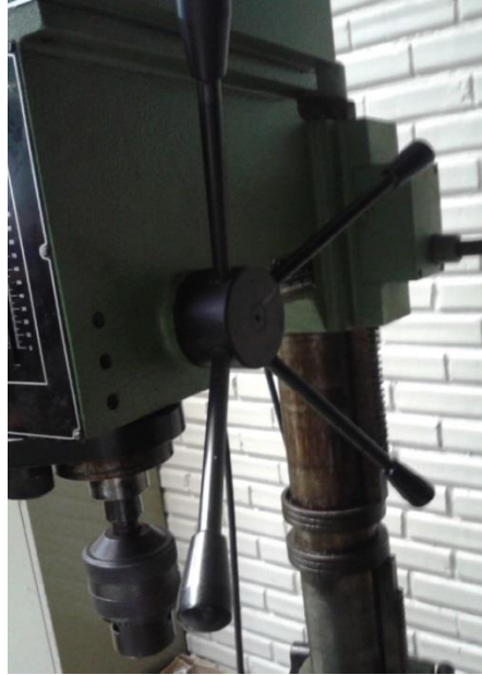
Figura 3.10 – Alavanca em cruz acoplada à furadeira de coluna
