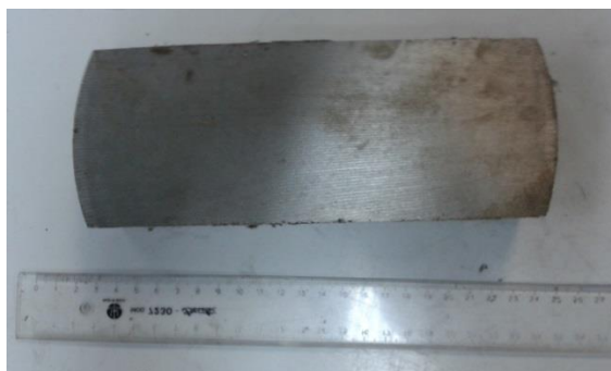
Figura 3.17 - Formato do corpo de prova de FE45012 após serramento, permitindo fixação na morsa.
