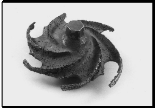
Figura 7 - Falha por cavitação e corrosão de um rotor de aço inox 316.
