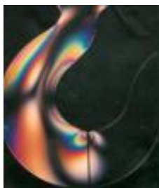
Figura 6. Visualização das tensões em um gancho utilizando a técnica fotoelástica.
