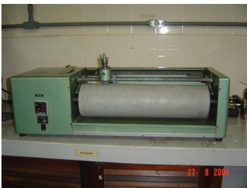
Figura 6 – Máquina montada e detalhe de peça que foi completamente desmontada, limpa e lubrificada.
