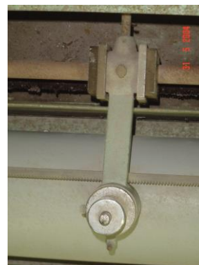
Figura 5 – Máquina Antes da Recuperação e peça necessitando de desmontagem, limpeza e lubrificação.
