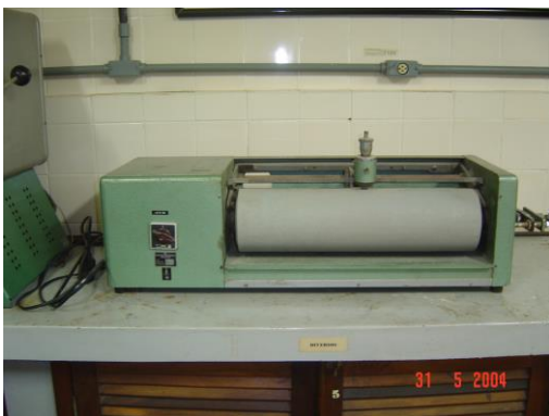
Figura 5 – Máquina Antes da Recuperação e peça necessitando de desmontagem, limpeza e lubrificação.
