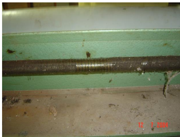
Figura 5 – Máquina em processo de Desmonte e Detalhe de incrustação de sujeira
